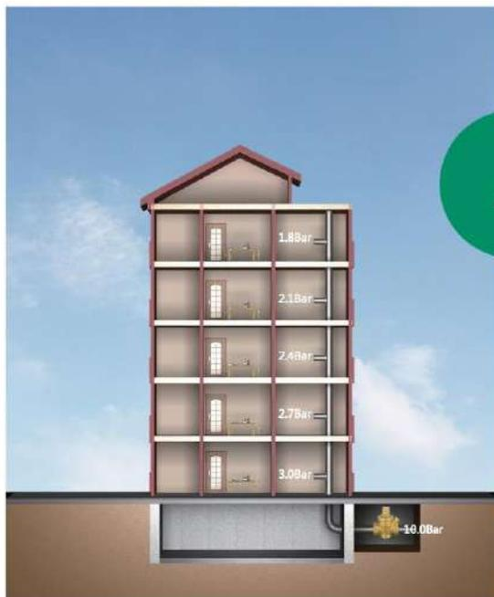
Pour bâtiments égal ou inférieur à 5 étages, le réducteur de pression peut être installé à la tuyauterie d'entrée principal ou branchement. Ceci génère un différentiel de pressions dans chaque étage. Si on prend comme exemple que chaque étage est de 3m d'hauteur, à mesure qu'on monte des étages se réduit la pression en 0,3Bar.
